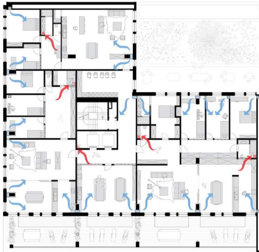
Logements: Alimentation en façade, extraction en sanitaires, groupe en toiture
