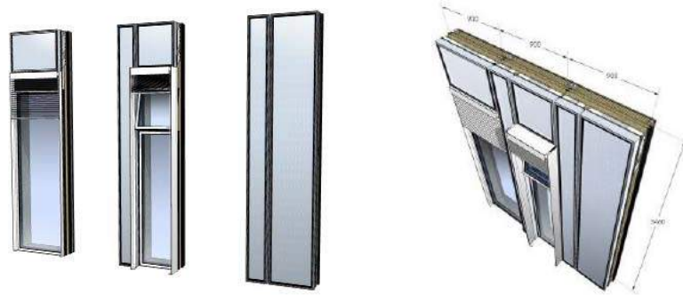
Figure 108: modules préfabriqués de 90 cm de large.
